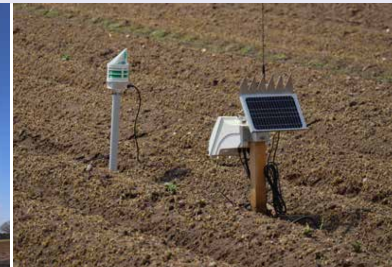
Abb. 3 Eingebaute Bodenfeuchtesensoren im Versuchsfeld (Quelle: INBW)
